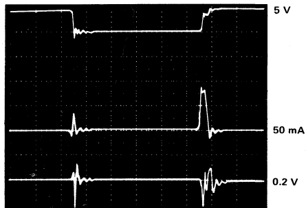
h) SN74AS1000 load: C_L = 50 \text{ pF}
